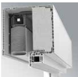
Der moderne Raffstore-Behang im Aufsatzkasten wird einfach durch Versetzen des Basisprofils ermöglicht. Nicht nur im gewerblichen sondern auch im privaten Bereich liegt der **Raffstore** im Trend. Mit speziellen Befestigungswinkeln wird dem Kasten zusätzlich Stabilität gegeben und der Raffstore-Behang wird fest mit dem Baukörper verbunden und der Kasten ist überputzbar. Beim Raffstore ist kein integrierter Insektenschutz möglich.
