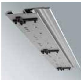
Elementbreiten bis 240 cm können bis zu einer Gebäudehöhe von 8 m dank des Spezial-Verstärkungseisens **ohne** Deckenanker eingebaut werden. Bei Fensterbreiten bis 350 cm ermöglicht die Statikkonsole aus verzinktem Stahl eine zusätzliche statische Verstärkung.
